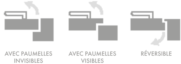
PORTES AVEC PAUMELLES VISIBLES, AVEC PAUMELLES INVISIBLES, RÉVERSIBLES
